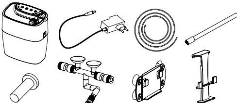
**Pompe** : La pompe fournie assure une action de pompage constante. S'il reste de l'air résiduel dans le système, la performance de pompage peut être réduite au début du processus.
