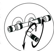
In het terrarium wordt de zwarte slang van sputilstuk naar sputilstuk gelegd. Het laatste mondstuk wordt afgesloten met de eindkap. Hij klikt wanneer de slang stevig in het mondstuk zit. Om het weer los te maken, moeten de uiteinden van het mondstuk naar beneden worden gedrukt. Plaats bij de installatie de zuignappen op het gladde glas en druk ze stevig aan om te waarborgen dat de sproeiers goed vastzitten.
