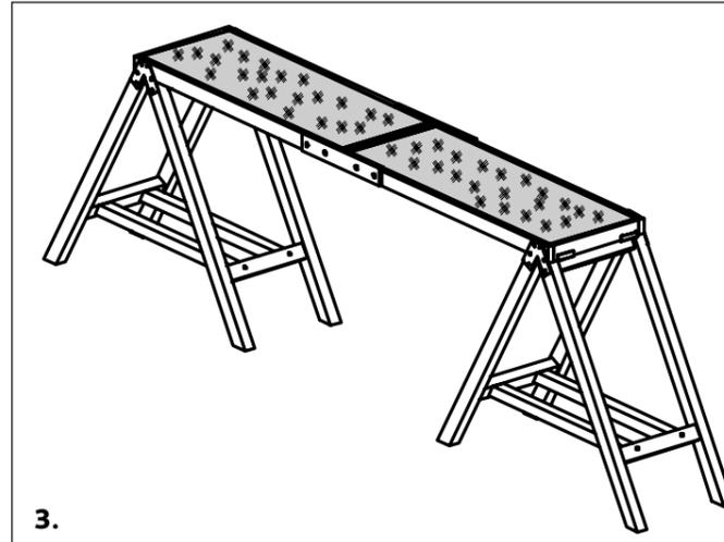
ⓓ Legen Sie die verbundenen mittleren Stegplatten auf die Böcke. Achten Sie auf einen waagerechten Stand des Steges. Befestigen Sie die Teile mit den Metallverbindern (D).
