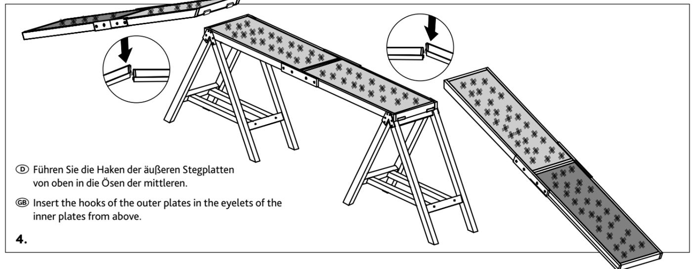
ⓓ Führen Sie die Haken der äußeren Stegplatten von oben in die Ösen der mittleren.
