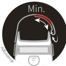
Nel caso della regolazione più stretta, le due superfici della chiusura a strappo si sovrappongono completamente (per massimizzare l'adesione). Se desideri allentare la cinghia, assicurati che la superficie del passante copra almeno il 50% della superficie a strappo per un supporto adeguato. (Adesione minima.)
