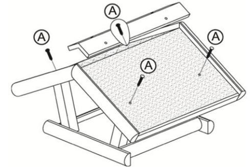
2. Befestigen Sie das Dach mit den Eckfeilern und verschrauben Sie den Dachfirst.
