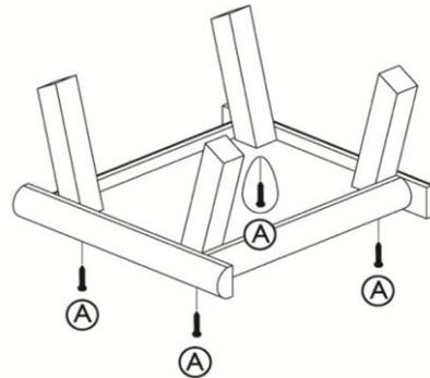
1. Verschrauben Sie die Eckfeiler (kurze Seite nach außen) mit der Bodenplatte.
