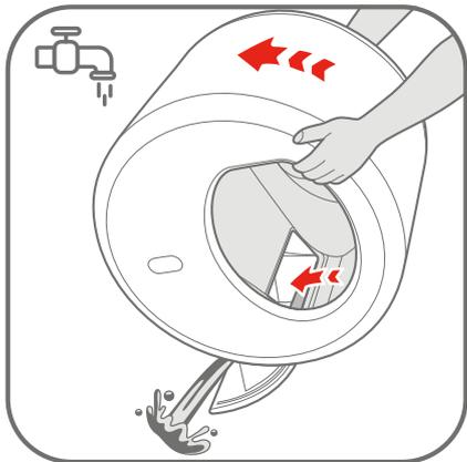
**2** Spüle die Trommel aus und drehe sie gegen den Uhrzeigersinn, um Restwasser abzulassen.
