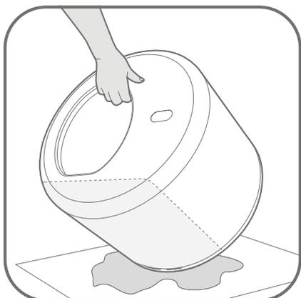
**4** Kippe die Trommel, um Restwasser unter der Silikonmatte ablaufen zu lassen. Vor dem Wiederaufbau gründlich an der Luft trocknen lassen.
